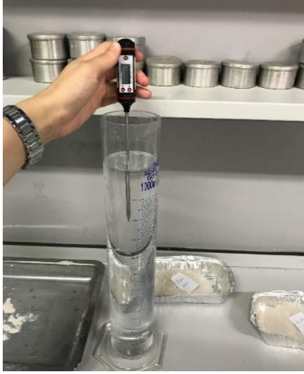
Şekil 4.6: Su Sıcaklığının Ölçülmesi
