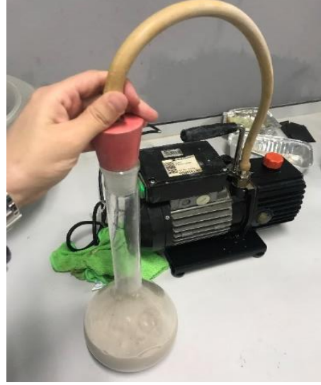
Şekil 4.7: Numunenin Hava Kabarcıklarından Arındırılması İçin Vakumlanması
