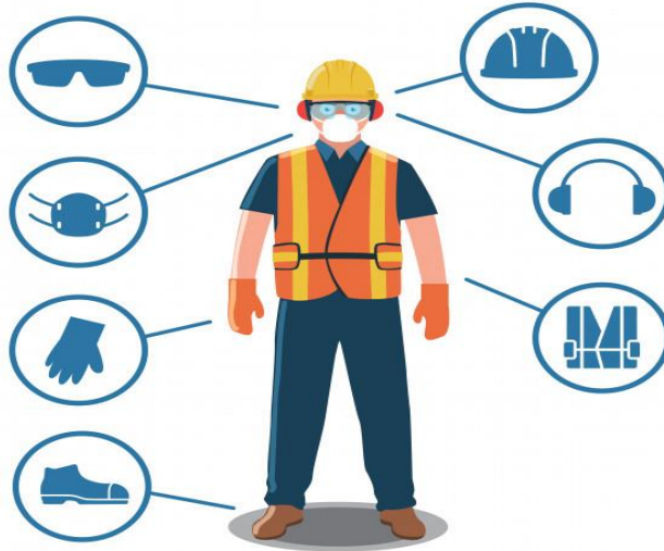
Şekil 4.2: Elektrikli çalışmalarda kullanılan KKD'ler
