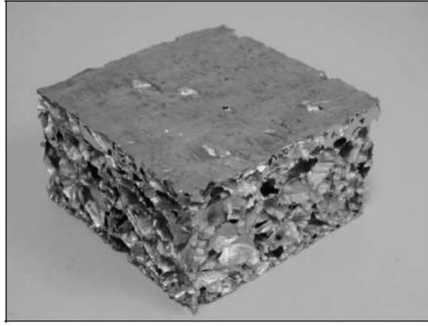
Şekil 4.4: Cymat Firması Tarafından Üretilmiş % 10 Yoğunluğa Sahip Köpük [27]
