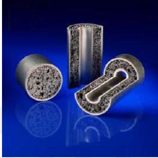
Şekil 4.12: Toz Metalürjisi İle Üretilmiş Alüminyum Köpük Dolu Tüp [39”]
