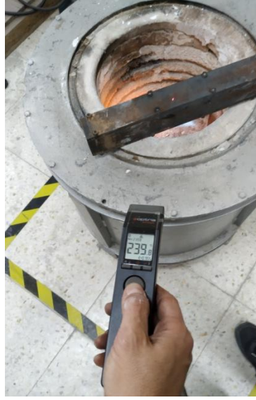
Şekil 9.7: Kalıp sıcaklığının ölçümü
