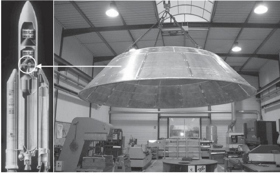
Şekil 6.5: Ariane 5 Raketinde Kullanılan Alüminyum Köpük Koni Adaptör [49]
