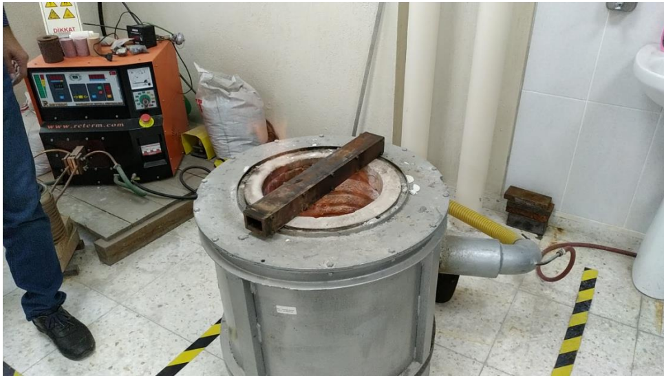
Şekil 9.6: Kalıbın döküm fırınında ısıtılması
