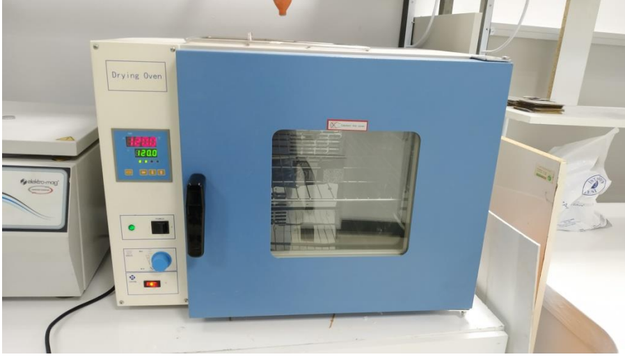
Şekil 9.16: Yapay yaşlandırma işlemi ve kullanılan fırın
