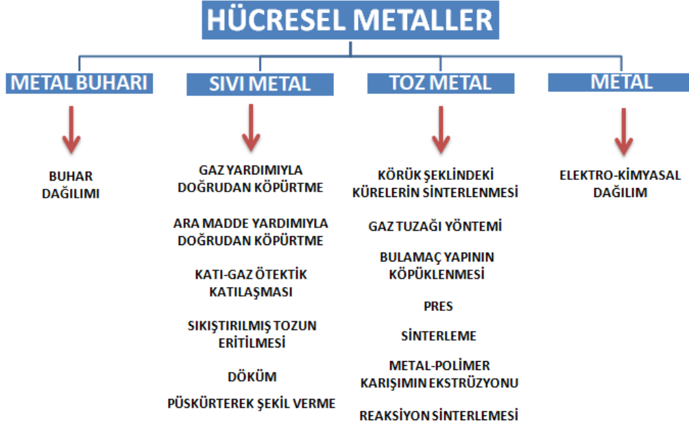
Şekil 4.1: Metalik Köpüklerin Üretim Yöntemleri [8]
