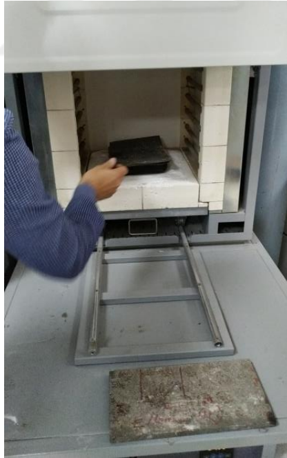
Şekil 9.4: Tuzun fırına yerleştirilmesi
