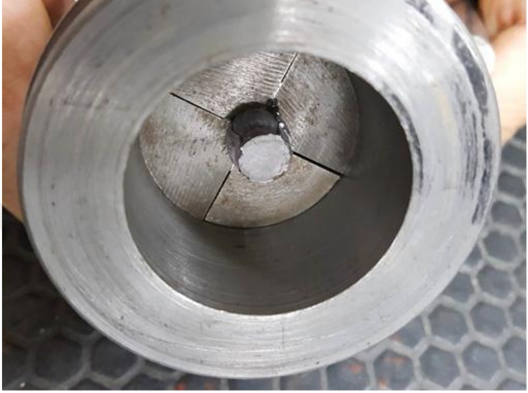
Şekil 3.8 TEB’de ekstrüzyon olup yığılan kurşunun görünümü
