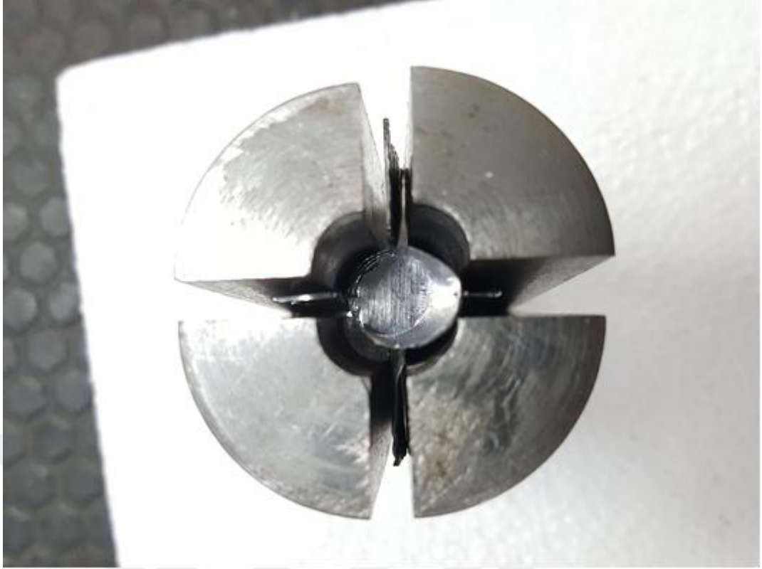
Şekil 3.10 Dört parçalı ekstrüzyon alıcısı arasına giren numunenin görünümü
