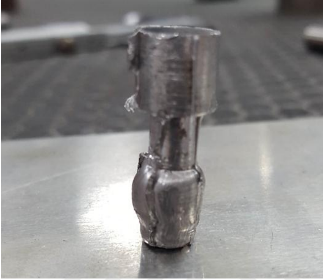
Şekil 3.9 Kurşun numunenin TEB deneyi sonrası görünümü
