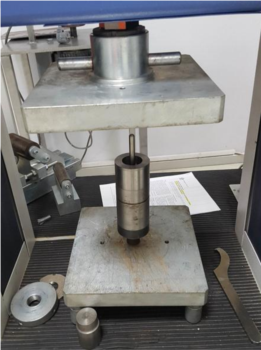
Şekil 3.7 TEB kalıbının basma cihazındaki görünümü
