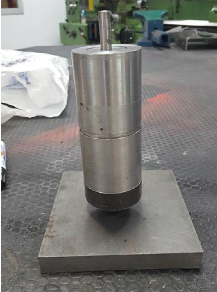
Şekil 3.5 Tekrarlı Ekstrüzyon Basması deney kalıbı
