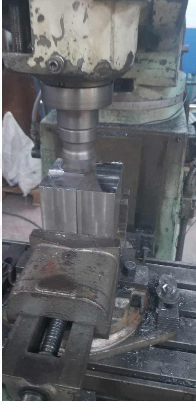
Şekil 3.12: Malzeme Yüzeylerinin Temizlenmesi 1
