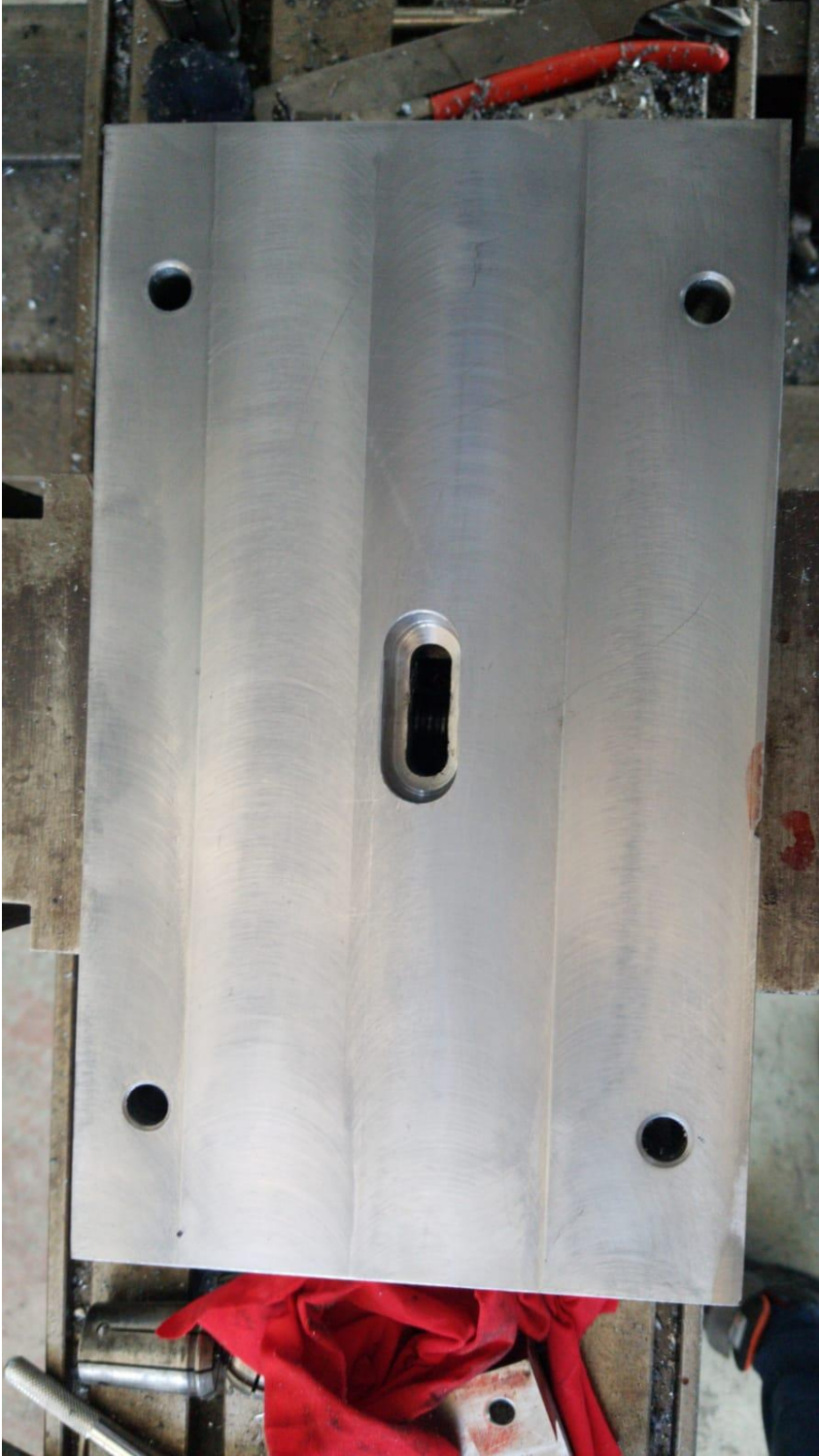
Şekil 3.17: Somun Tutucu Boşluğun İşlenmesi
