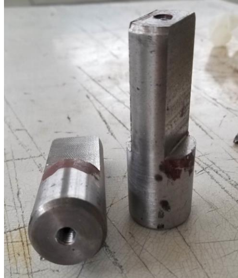
Şekil 4.7: İşlenmiş Tutucu Aparatlar
