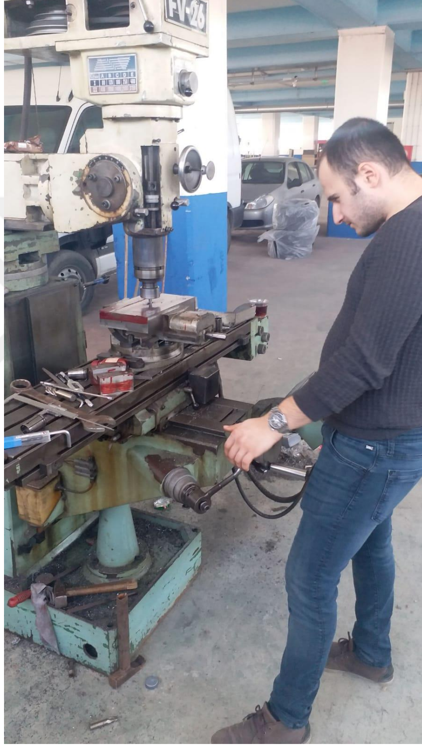
Şekil 3.16: Bağlantı Deliklerinin Açılması 2
