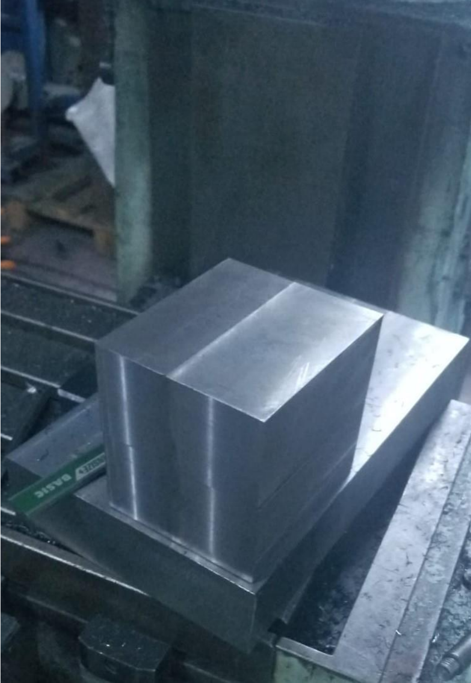
Şekil 3.13: Malzeme Yüzeylerinin Temizlenmesi 2
