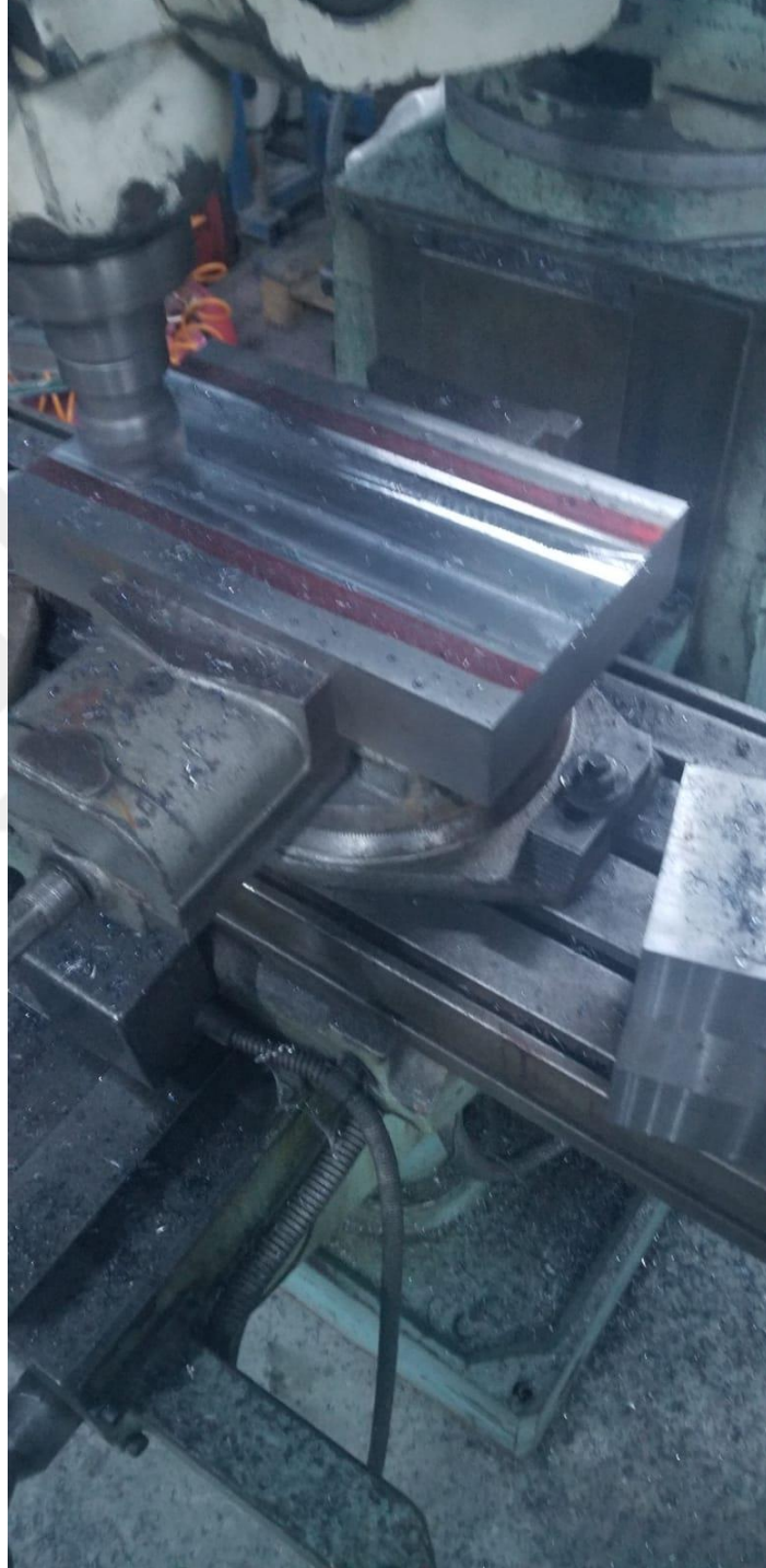
Şekil 3.14: Ana Tutucu Para Üzerine Hareket Kanalı Açılması
