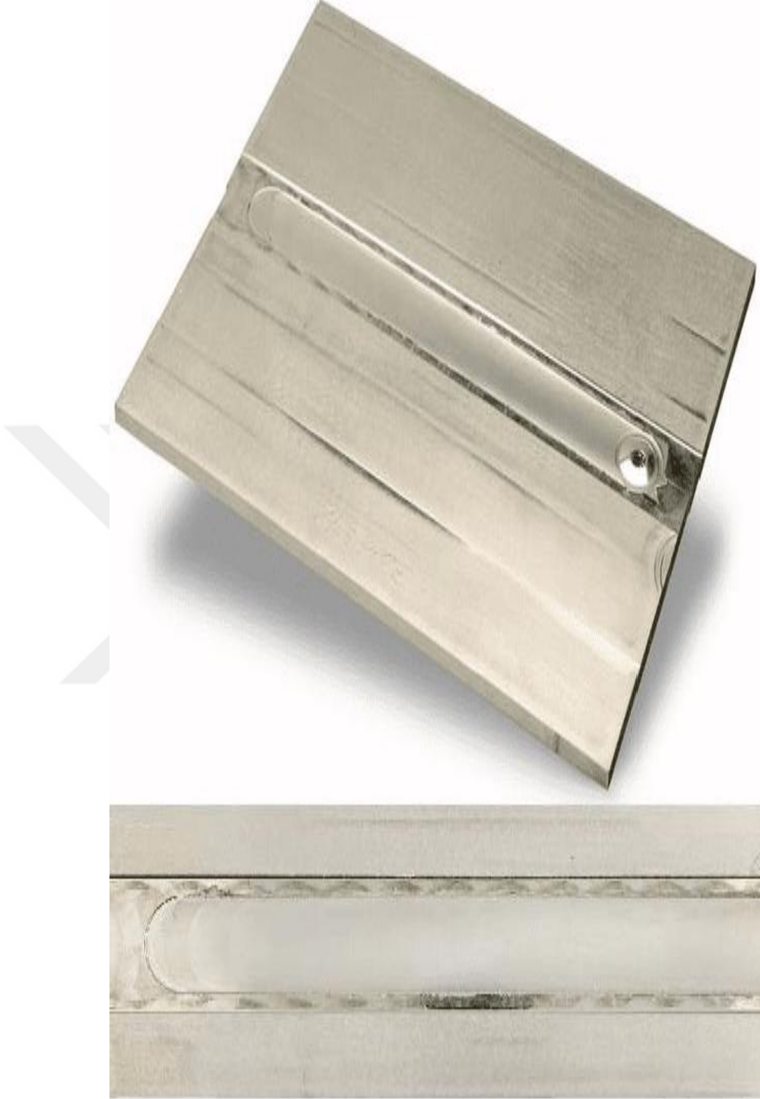
Şekil 3.2: Sürtünme Karıştırma Kaynağı İşleminden Sonra Dikiş Görünümü
