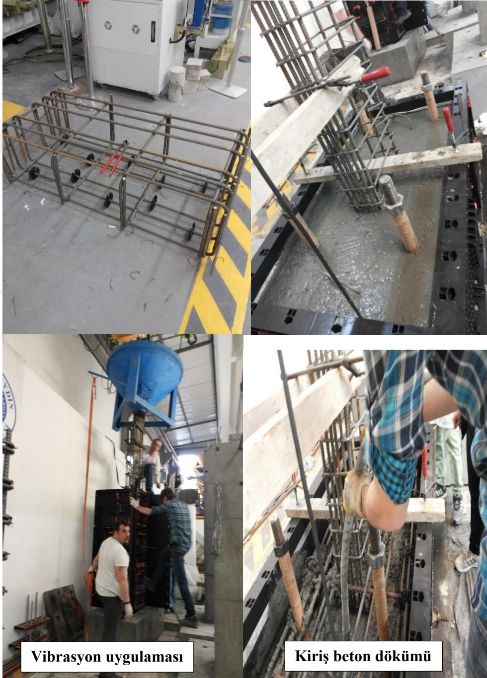
Şekil 2.3: KY01-3.6 Numunesinin İmalat Aşamalarına Ait Fotoğraflar
