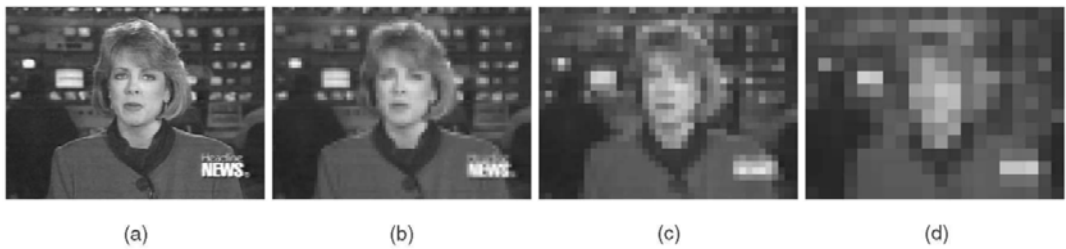
Şekil 7.2 : (a) n = 1 , orijinal görüntü. (b) n = 4 . (c) n = 8 . (d) n = 16 . Orijinal ve karşılık gelen düşük çözünürlüklü görüntüler.
