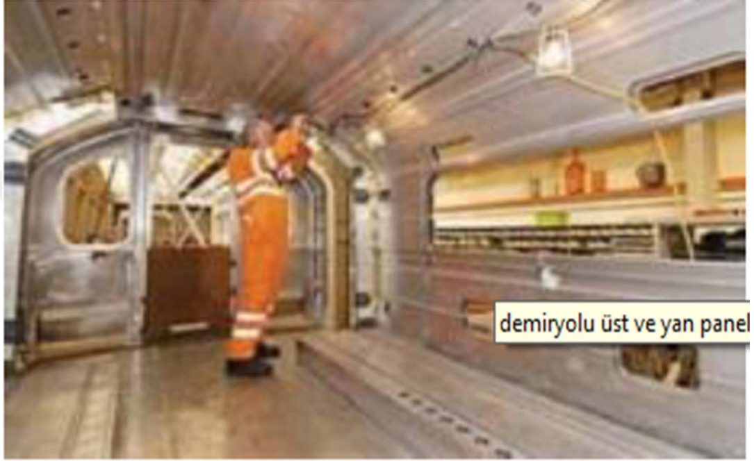
Şekil 2.6: Tren yapımında SKK kullanımı
