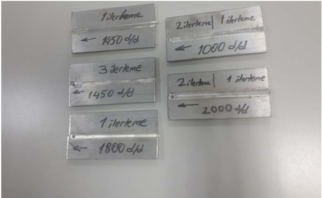
Şekil 3.11: Kaynak sonrası alüminyum parçaların ilerleme hızı ve devir sayısına göre dağılımı
