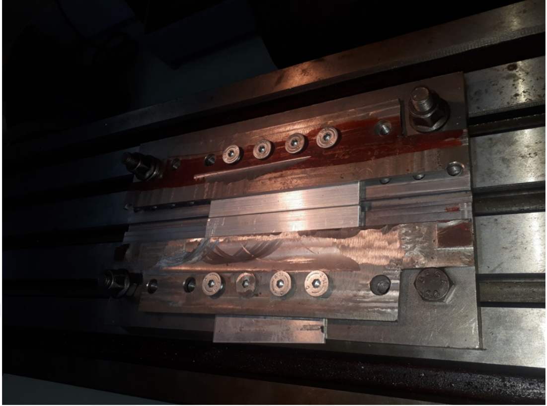
Şekil 3.3: Alüminyum Parçaların Alt Kalıba bağlanma İşlemi
