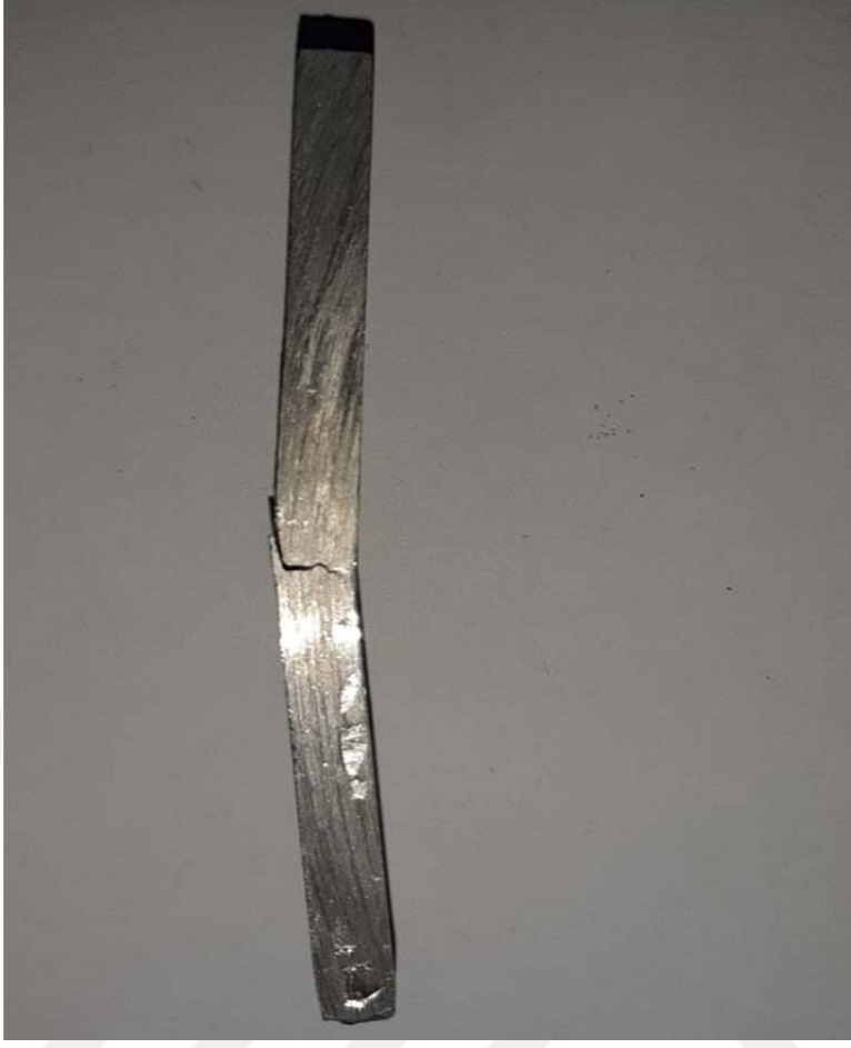
Şekil 3.14: Eğme testi sonrası çatlama görünümü
