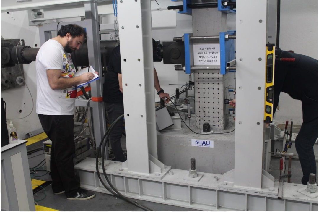
Şekil 3.3: Ultra ses cihazıyla yapılan ölçümler
