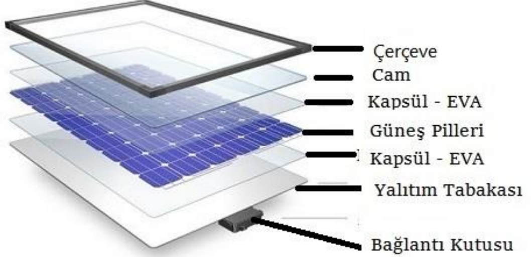
Şekil 2.10: PV Panelin katmanları, (Url-9)
