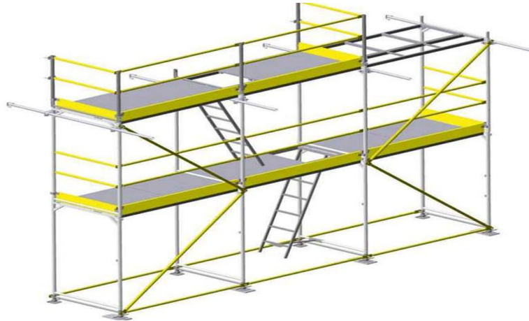
Şekil 2.23: EN 12811 Dikme Birleşimleri
