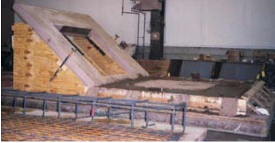
Şekil 6-11: Üretim aşamasında beton esaslı prekast ağır cephe paneli örneği
