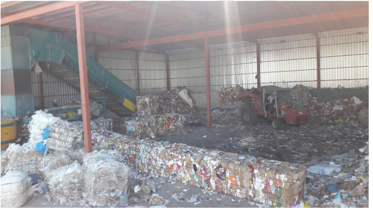
Şekil 2.7.8.1.2.a) : Atıkların Presleme İşlemi
