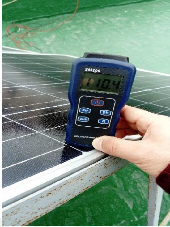
Şekil 15 Solar Meter ile Işınım Ölçümü
