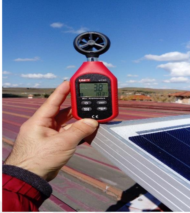
Şekil 39 Anemometre İle Ölçüm Düzenegi
