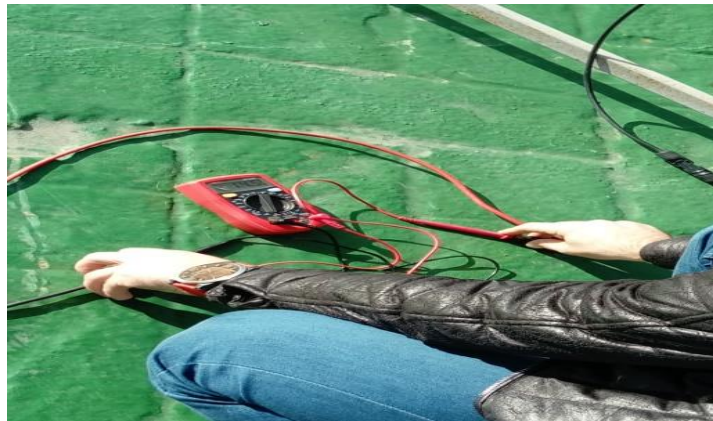
Şekil 17 Multimetre ile Akım ve Gerilim Ölçümleri
