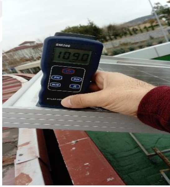
Şekil 14 Solar Meter ile Işınım Ölçümü
