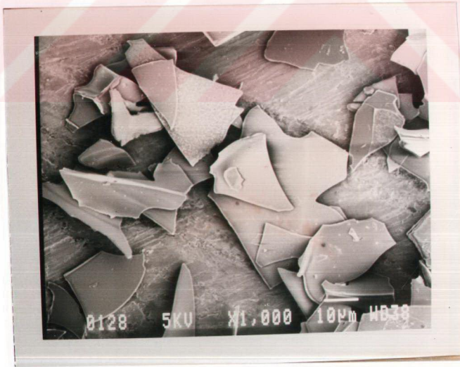
Şekil 4.4 0.6 M H- Genleşmiş perlitin 1000 kat büyütülmüş SEM fotoğrafı
