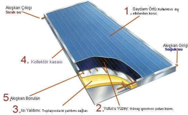
Kaynak: http://www.tesisat.org/duz-yuzeyli-gunes-enerjisi-kollektorleri.html Şekil 2.15 Kollektörü Oluşturan Elemanlar
