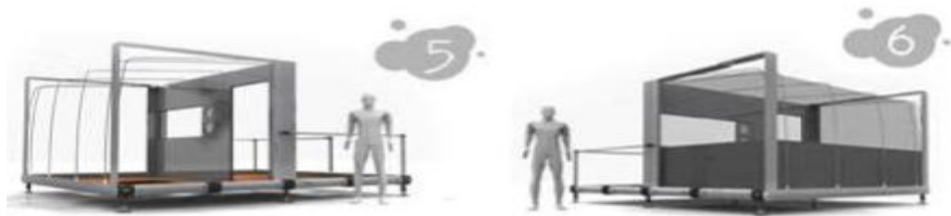
Şekil 3.41. Uber Barınağı Montaj Aşamaları 3 (Beyazıt, 2008: 44)
