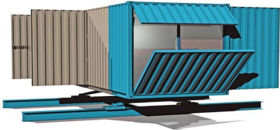
Şekil 3.13. Minimum Taşınabilir Modül Kapı ve Pencere Eklenebilirliği (worldarchitecture.org, 2018)
