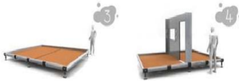
Şekil 3.40. Uber Barınağı Montaj Aşamaları 2 (Beyazıt, 2008: 44)
