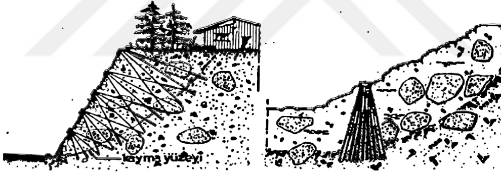
Şekil 2.17 Yamaç stabilitesinde mini kazık uygulaması
