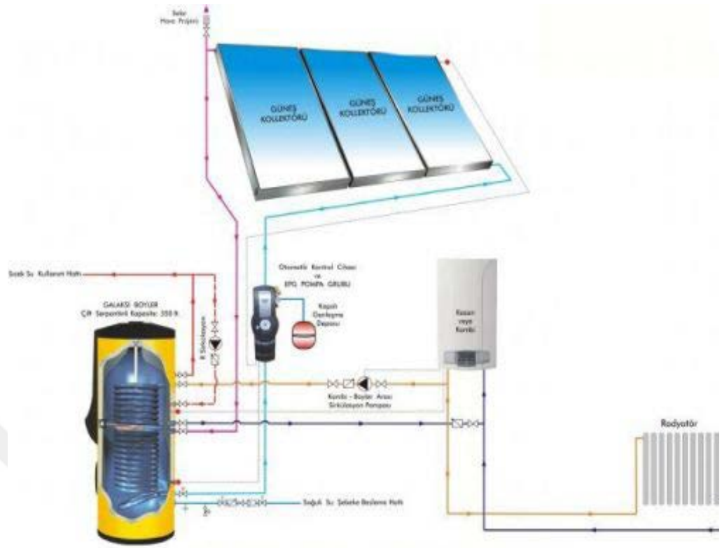
Şekil 1.3. Güneş Enerjisi Sıcak Su Proje Şeması.
