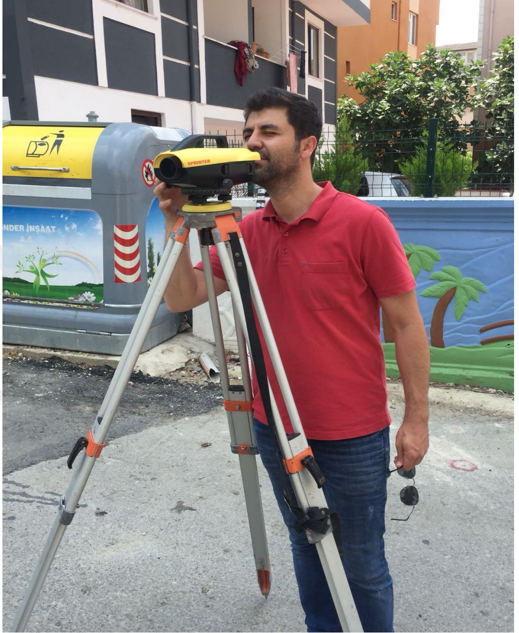
Şekil 1.2. Kot Kesit Ölçümünün Arazide Uygulaması
