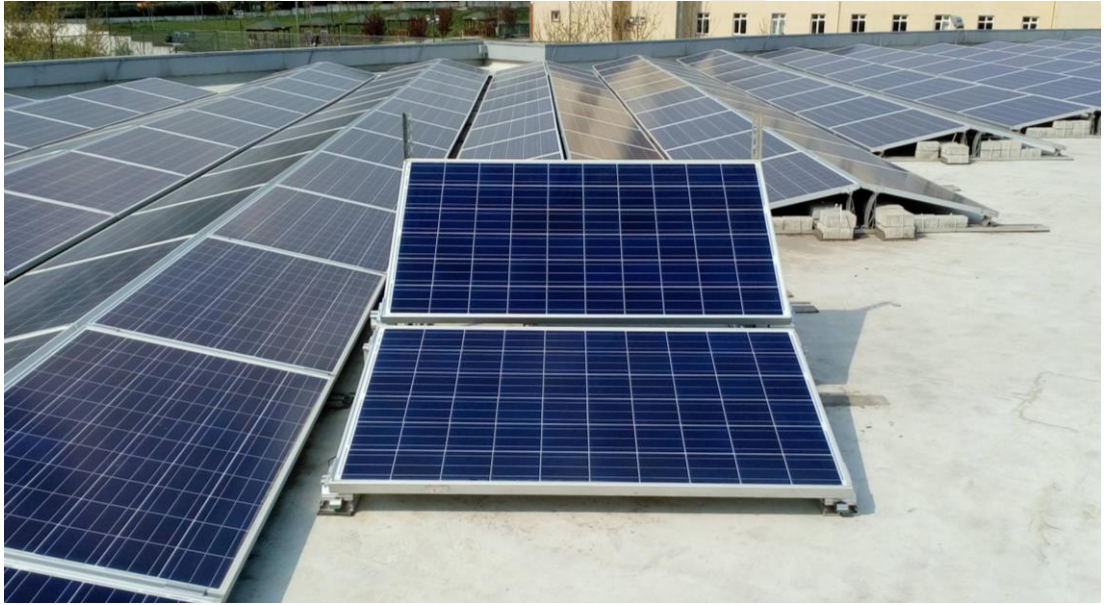
Şekil 6.3. 30° Güney yönelimli ölçüm için hazırlanan deney düzeneği görüntüsü
