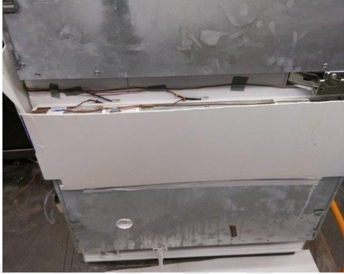
řekil 3.3. Mevcut Contanın Sıcaklık Ölçümü Deney Düzenegi
