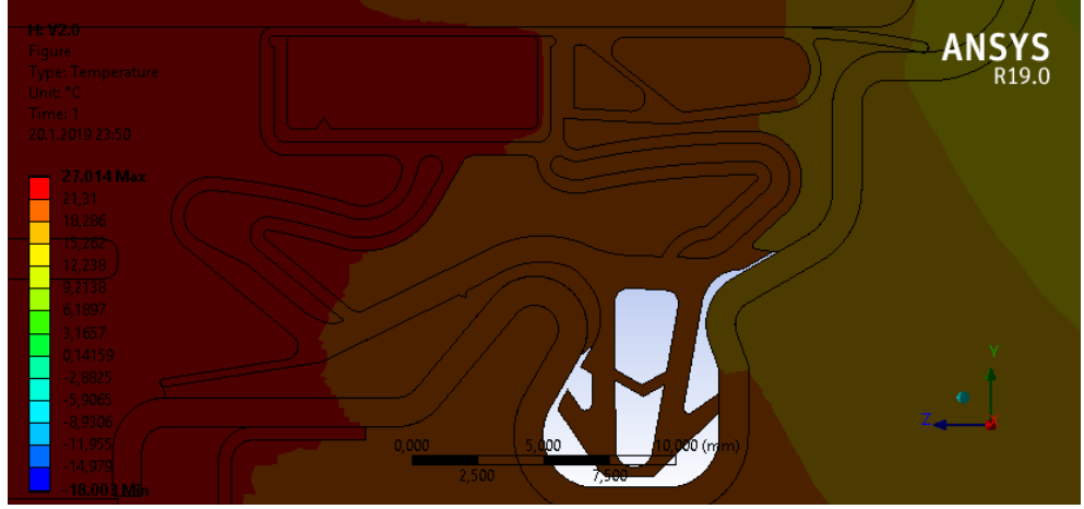
Şekil 4.12. Yeni Conta Tasarımının Sıcaklık Dağılımı-10.Tasarım
