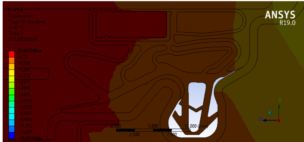
Şekil 4.8. Yeni Conta Tasarımının Altıncı Tasarımının Sıcaklık Dağılımı
