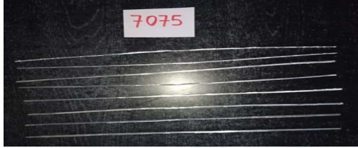
Resim 9.5. 7075 - T651 Alüminyum Alaşımını ; kendi malzemesi ile kaynağını yapmak için, kendi malzemesinden, kalınlığı 2,4 mm parçalar kesilerek, kaynak teli üretilmiştir.
