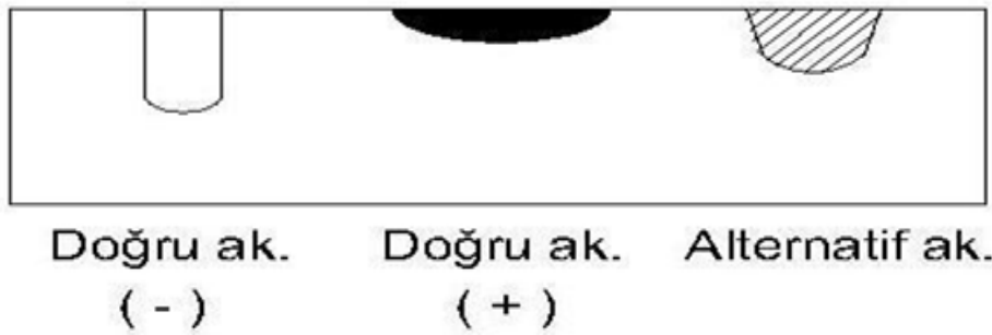
Şekil 6.10. TIG kaynağında kullanılan akıma ve kutba göre dikiş formları
