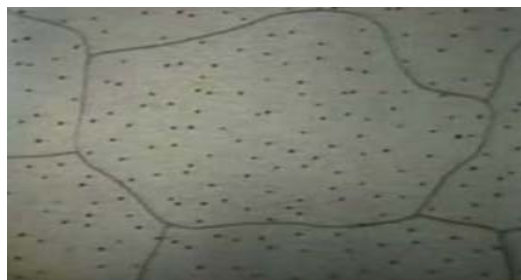
Resim 7.3. Yaşlandırma işlemi sonucu oluşan aşırı doymuş α fazı içerisinde meydana gelen β faz çöktelleri.
