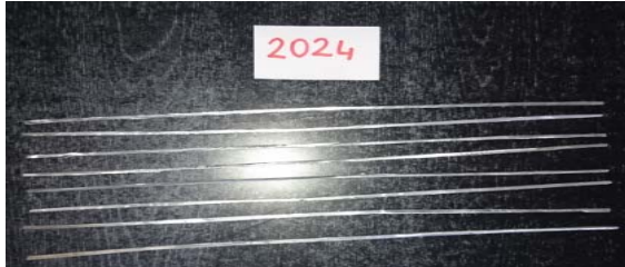
Resim 9.6. 2024 - T351 Alüminyum Alaşımını ; kendi malzemesi ile kaynağını yapmak için, kendi malzemesinden, kalınlığı 2,4 mm parçalar kesilerek, kaynak teli üretilmiştir.
