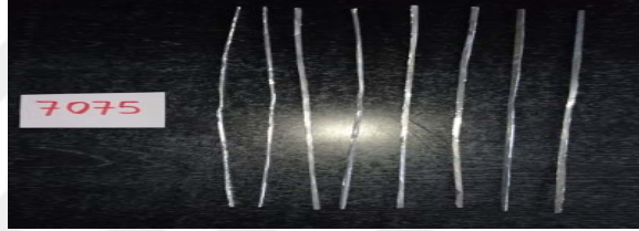
Resim 9.5. 7075 - T651 Alüminyum Alaşımını ; kendi malzemesi ile kaynağını yapmak için, kendi malzemesinden, kalınlığı 2,4 mm parçalar kesilerek, kaynak teli üretilmiştir.
