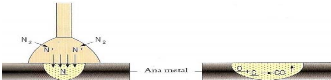
Şekil 6.19. Kaynak banyosunda gaz hapsolmesi [ 23]
