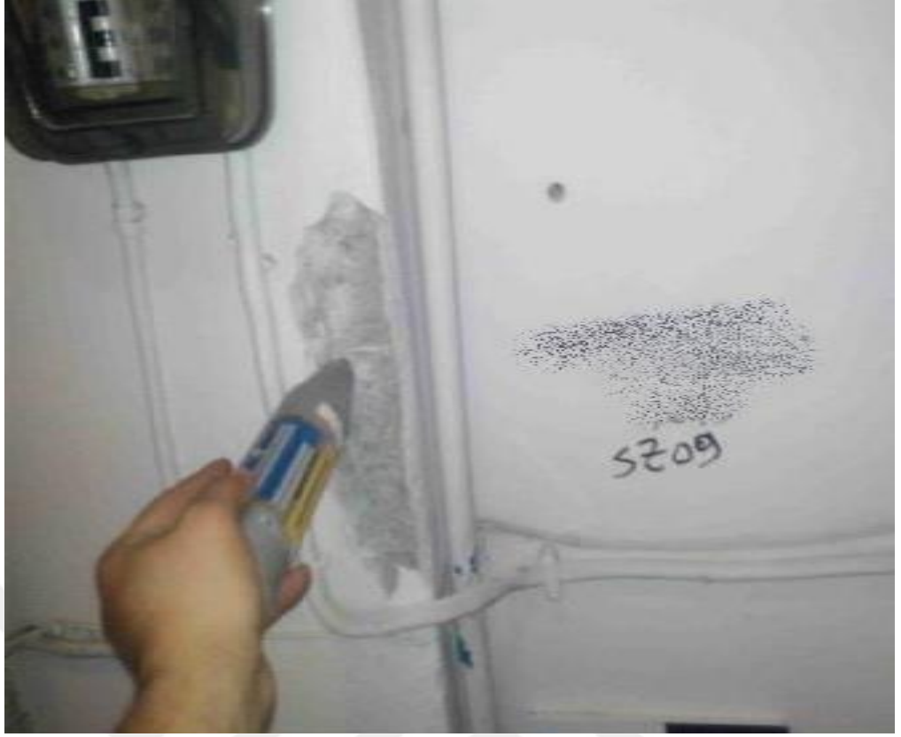
Resim 28. SZ09 Kolonu Schmidt Deney Yapılışı
