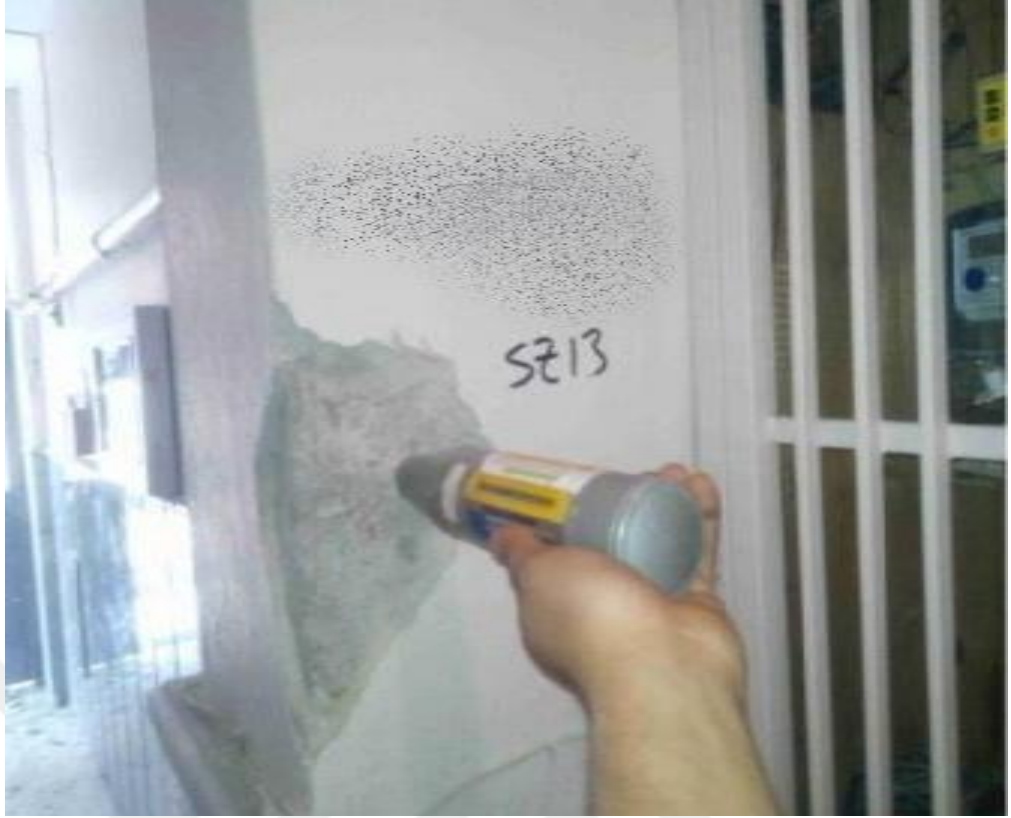
Resim 30. SZ13 Kolonu Schmidt Deney Yapılışı
