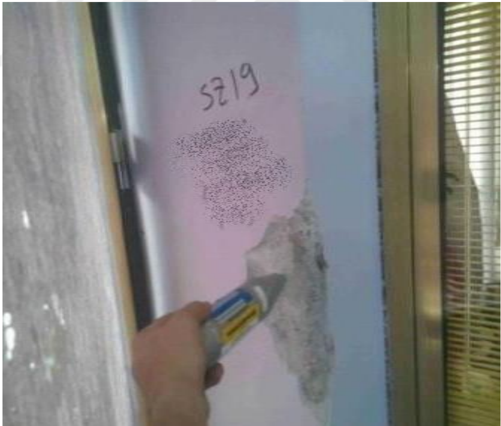
Resim 27. SZ19 Kolonu Schmidt Deney Yapılışı
