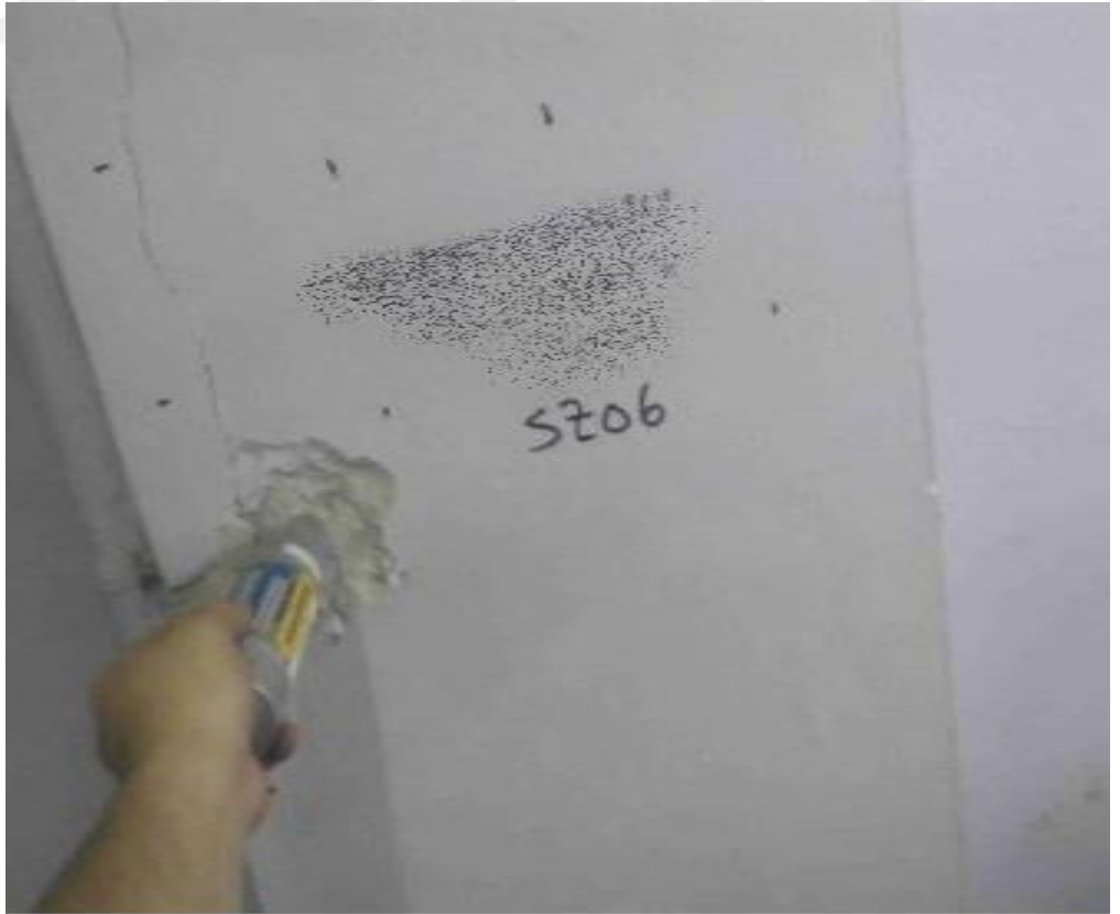
Resim 25. SZ06 Kolonu Schmidt Deney Yapılışı
