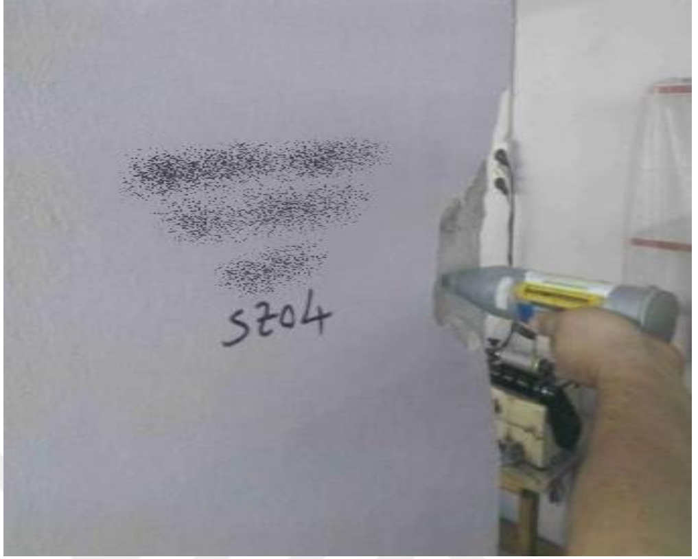
Resim 24. SZ04 Kolonu Schmidt Deney Yapılış
