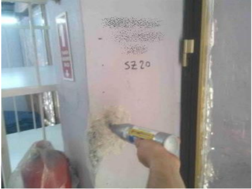
Resim 26. SZ20 Kolonu Schmidt Deney Yapılışı
