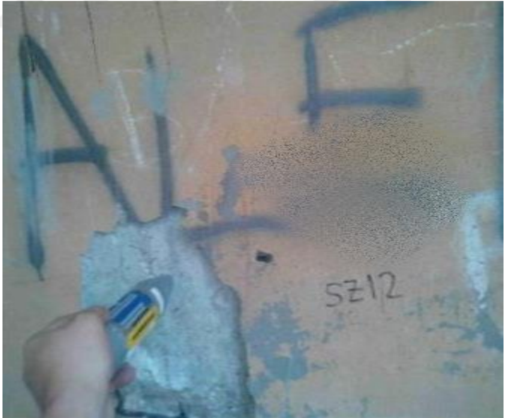
Resim 33. SZ12 Kolonu Schmidt Deney Yapılışı
