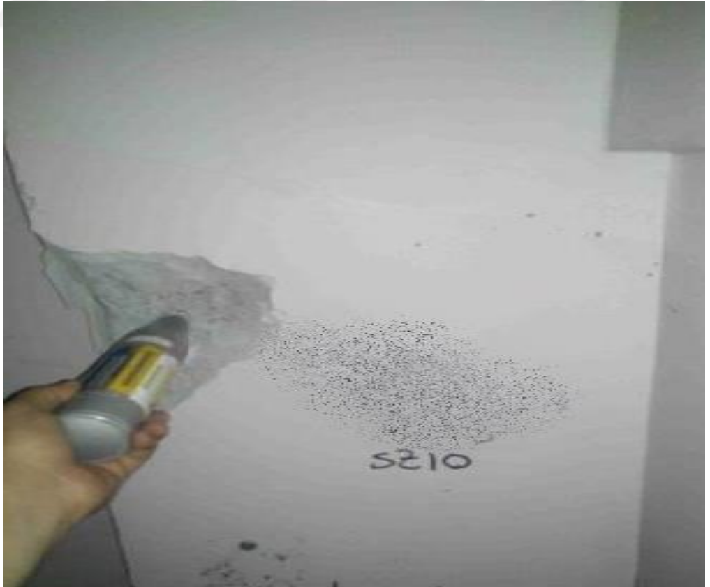
Resim 29. SZ10 Kolonu Schmidt Deney Yapılışı
