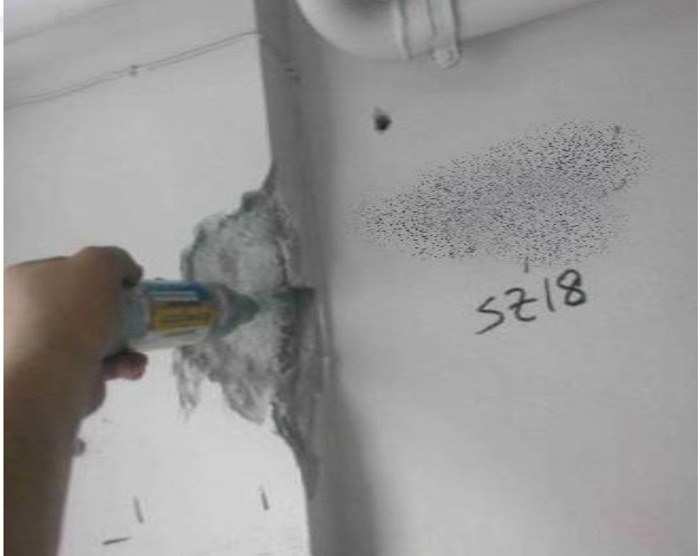
Resim 31. SZ18 Kolonu Schmidt Deney Yapılışı
