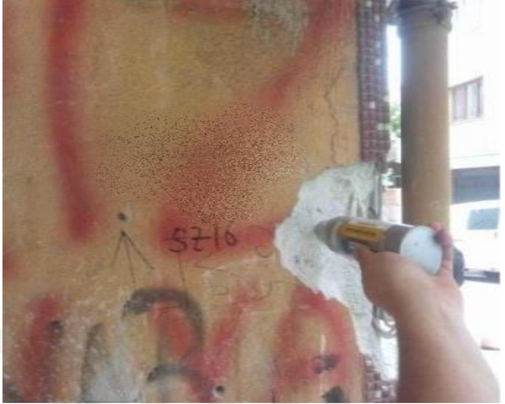
Resim 32. SZ16 Kolonu Schmidt Deney Yapılışı
