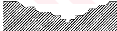
72-İç içe kanal
