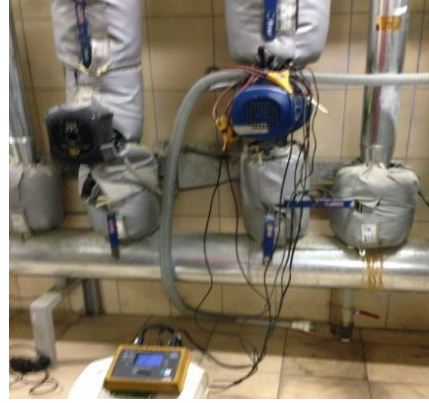
Şekil 2.96. Havuz Eşanjör Pompası debi ve Güç Ölçümü
