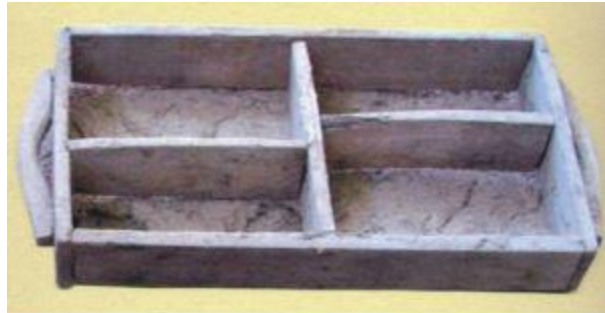
Şekil 2.24. Dört Gözlü Ahşap Kerpiç Kalıbı
