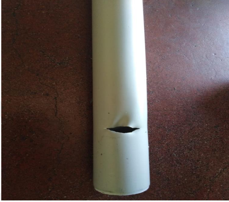
Şekil 7. Parça gelmesi sonucu dalgalı boru firesi
