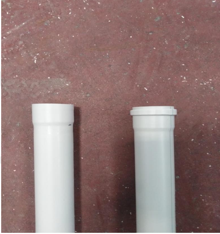
Şekil 8. Muflama hatası ( Sağdaki sağlam ürün, soldaki hatalı ürün)
