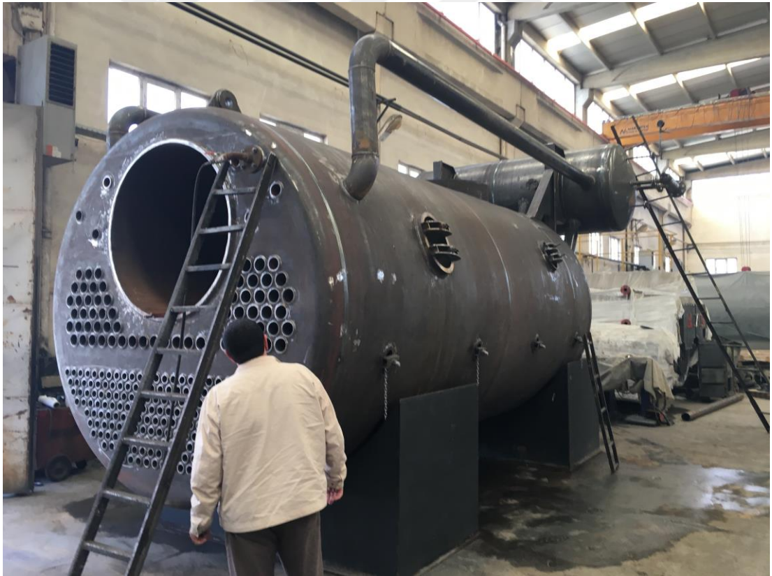
Şekil 6.7 Alev borulu buhar kazanı fabrika muayenesi
