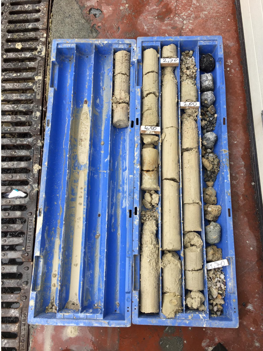
Şekil 6.1 Zemin etüdü için alınan numuneler
