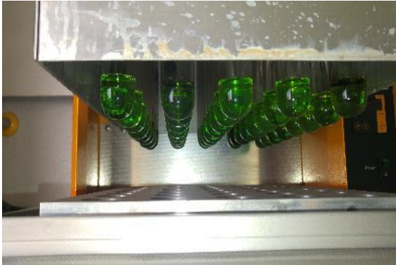
Şekil 3.21. Azot tayini için yağ yakma
