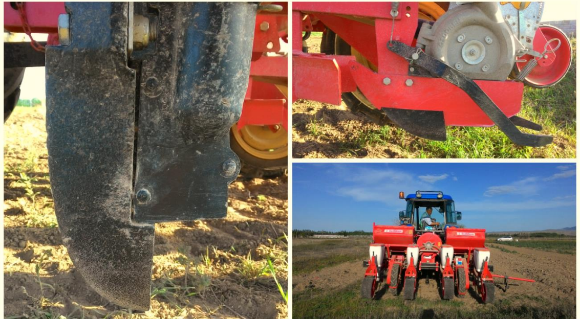
Şekil 3.2. Çizi açıcı (gömücü) ayaklar ve baskı tekerlekleri
