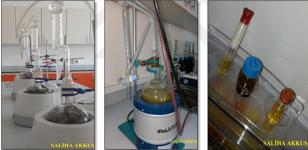
Şekil 3.4. Öğütülen bitkilerin Hidrodistilasyon yöntemiyle uçucu yağların elde edilmesi ve cam tüpler içinde +4°C de buzdolabında muhafaza edilmesi
