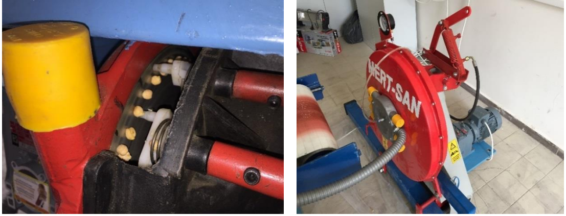
Şekil 3.3. Tohum tekleme ayarı ve fan ünitesi
