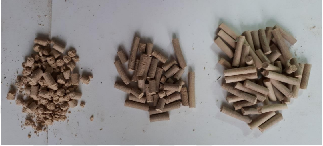
Şekil 3.12. Nem içeriğinin %25'e çıkarılmasıyla, sırasıyla 50, 60 ve 70 °C materyal sıcaklığında elde edilen peletler.
