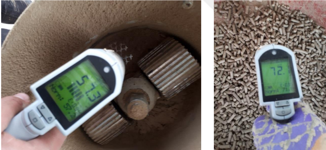
Şekil 3.13. Peletleme makinası ve peletlerde yapılan sıcaklık ölçümleri
