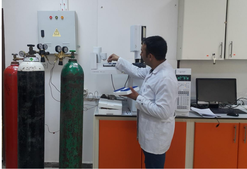
Şekil 3.1 Bakteri strainlerinin yağ asit metil ester analizi için örneklerin MIS cihazı üzerindeki örnek depolama tepsisine yerleştirilmesi
