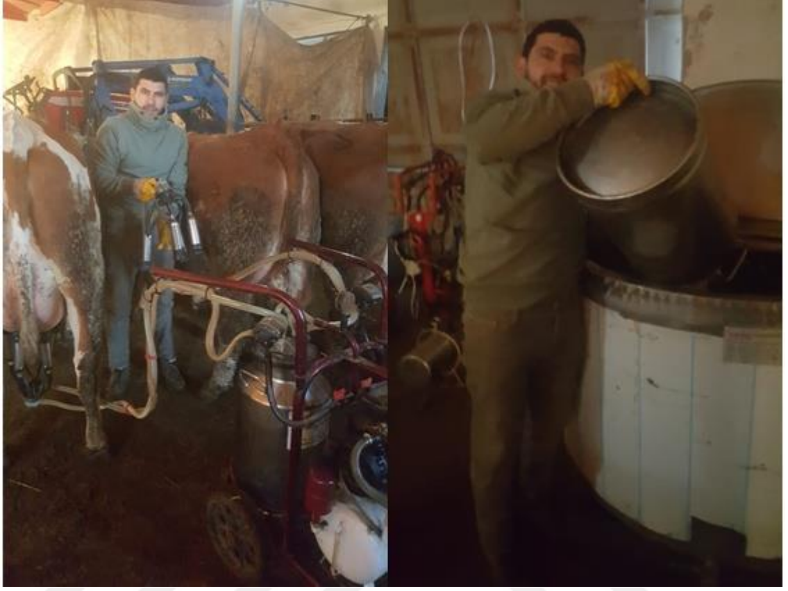
Şekil 4.2. İşletmede süt sağım makinesi ve soğutmalı süt toplama tankı
