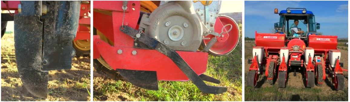
Şekil 3.2. Çalışmada kullanılan gömücü ayaklar ve baskı tekerlekleri
