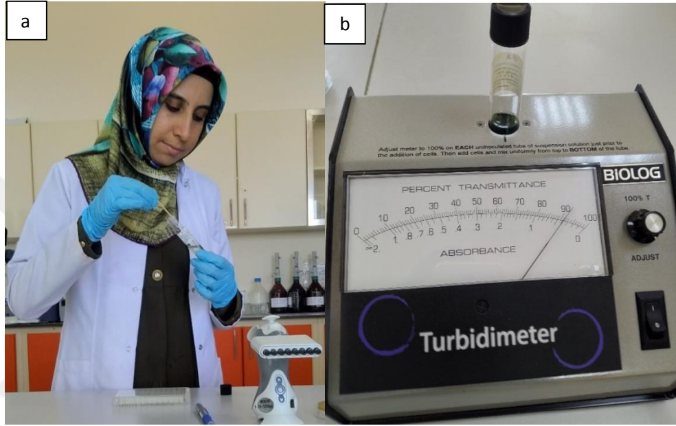
Şekil 4.4. Bakteri strainlerinin BIOLOG IFA çözeltilisinde süspansiyon edilmesi (a) ve turbidimetre ile konsantrasyonun ayarlanması (b)
