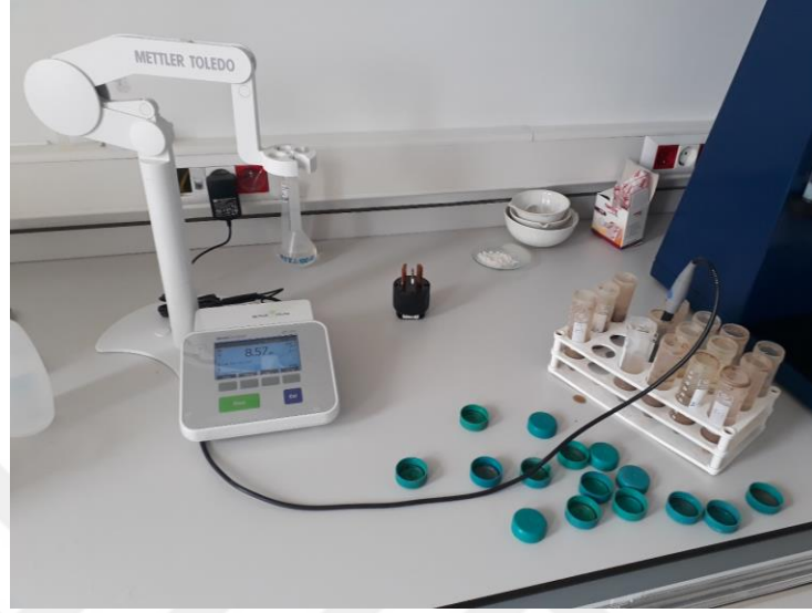
Şekil 3.8. Ph değerlerinin ölçülmesi
