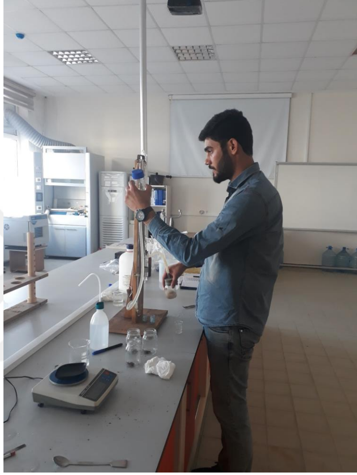
Şekil 3.9. Kireç değerlerinin ölçülmesi
