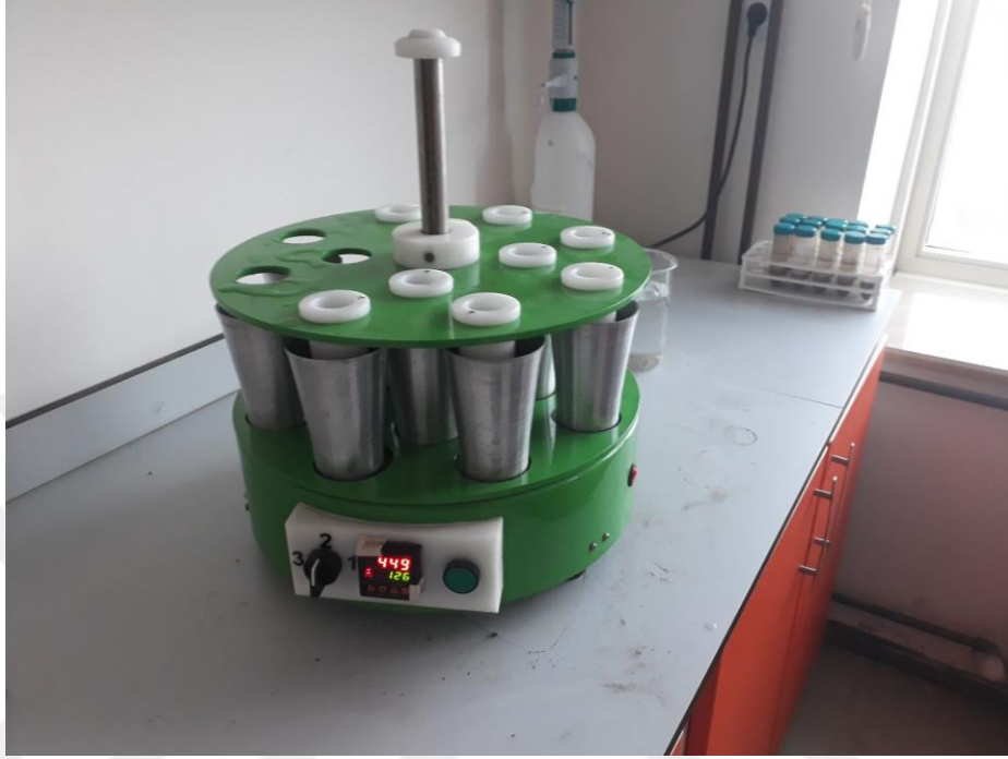
Şekil 3.5.Yoder tipi ıslak eleme aleti
