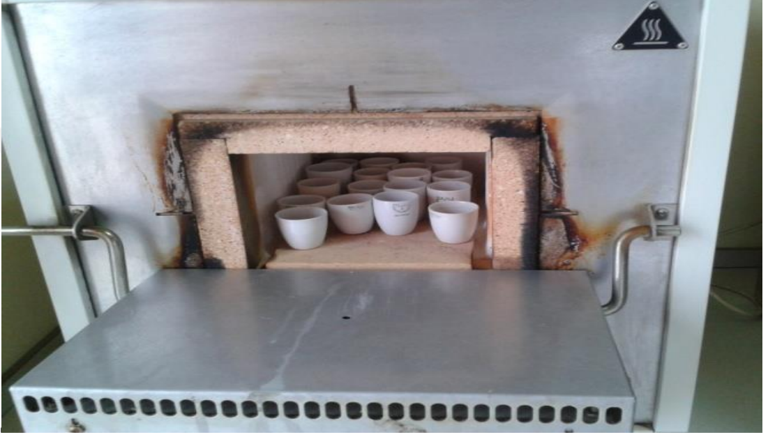
Şekil.3.3. Silaj örneklerin ham kül fırınında yakılması
