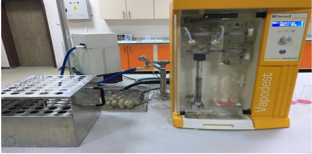
Şekil.3.5. Örneklerin ham protein analizinde destilasyon işlemi
