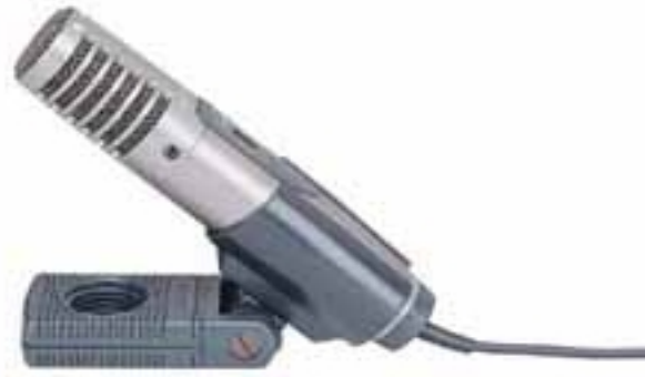
Şekil 1.19 Bir elektret-kapasitif mikrofon 27
