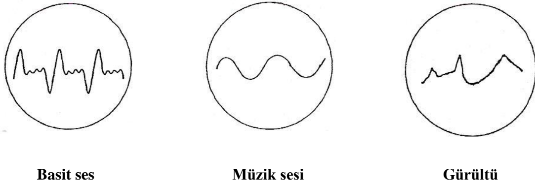
Şekil 2. Seslerin osiloskoptaki görüntüleri
