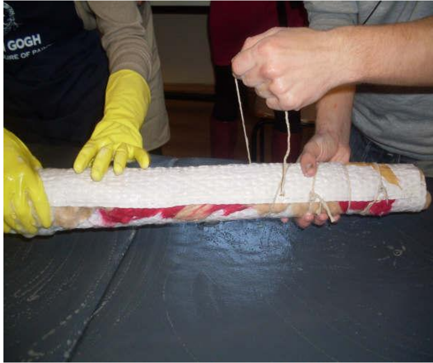
Şekil.5.20. Tepme keçe yapımında rulonun bağlanması. Kaynak: Sarıoğlu, Haliç Üniversitesi, Ders Notları , (25 Kasım 2008)
