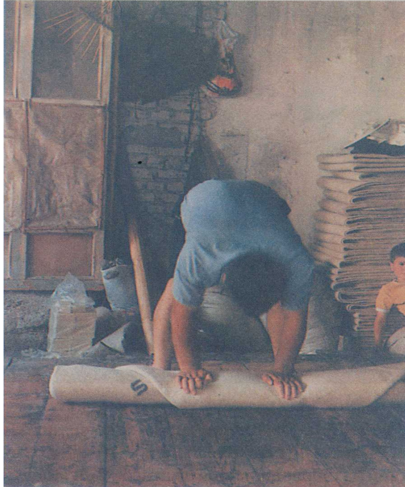
Şekil.5.29. Atölye ortamında pişirme işleminin elle yapılması (Bergama, 1992) Kaynak: Ergenekon, 1999, s. 74.
