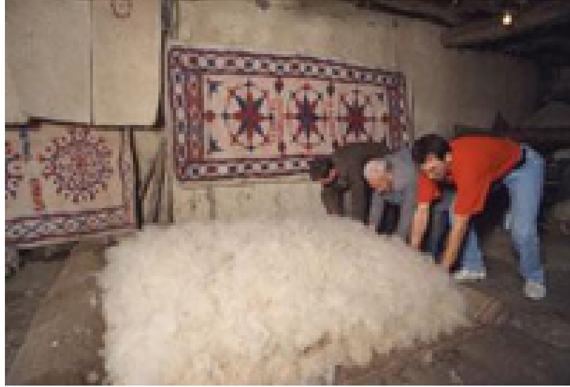
Şekil.5.16. Tepme keçe yapımında yün saçma işlemi.
