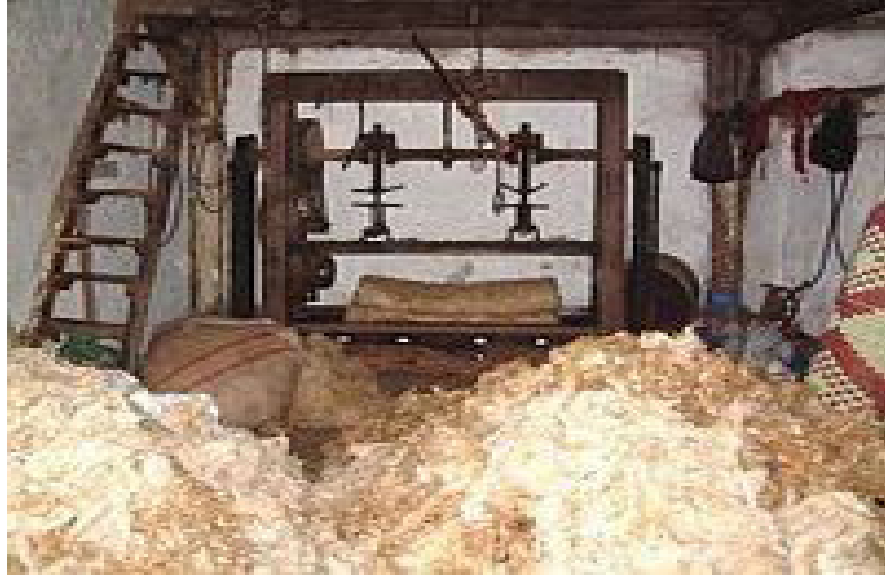
Şekil.4.8. Yün elyafının atılmasında kullanılan hallaç makinesi.
