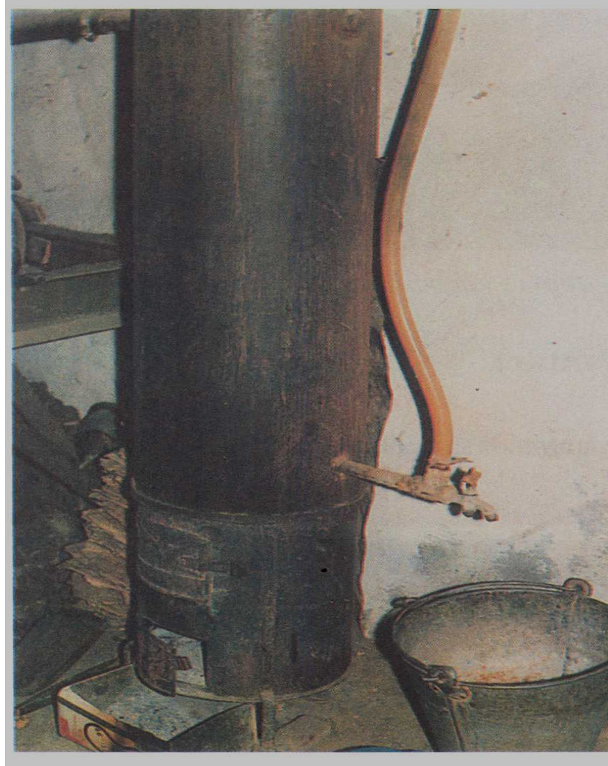
Şekil.4.26. Pişirme işleminde kullanılan buhar kazanı (Afyon, 1992) Kaynak: Ergenekon, 1999, s. 60.
