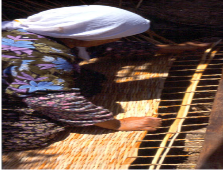
Şekil.4.10. Tepme keçecilikte kullanılan kalıp veya hasır örtü.
