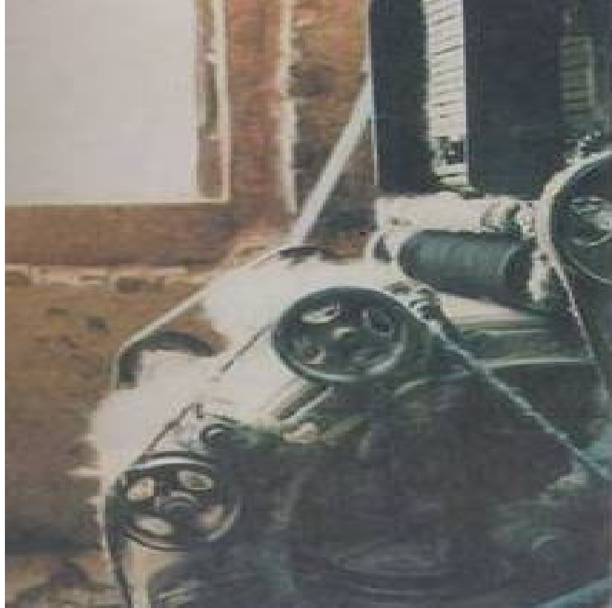
Şekil.5.4. Yünün atılması işleminde kullanılan hallaç makinesi.
