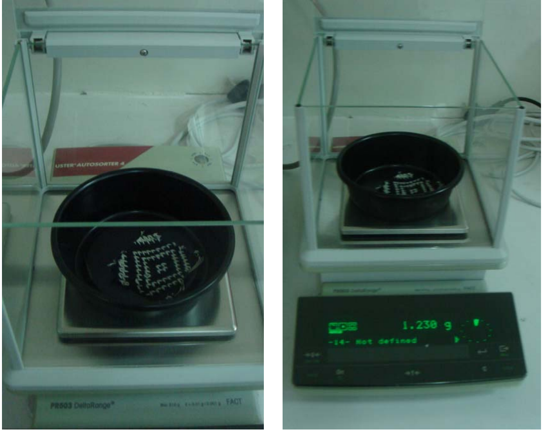
Şekil: 6.45 Kumaşın hassas terazide tartılması Kaynak: Alev Çırpıcı (23 Aralık 2008)
