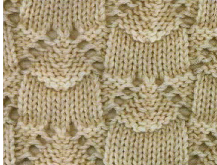
Şekil: 5.29 Aktarmalı örme kumaş
