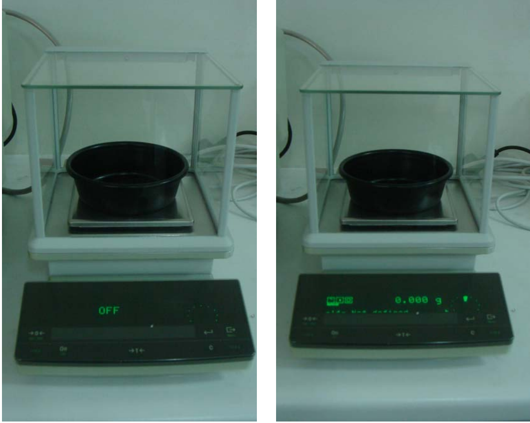
Şekil: 6.44 Hassas terazinin ölçüme hazırlanması, sıfırlanması
