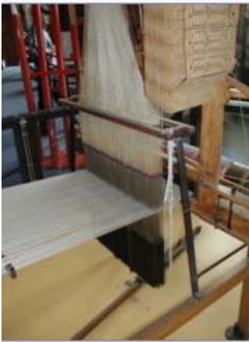
Şekil: 2.10 İlk jakar dokuma makinesi resimleri
