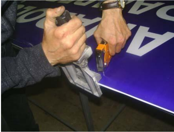
Şekil 3.3 Yerinde Vinil Germe Tekniği
