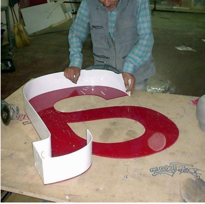
Şekil 3.8 Plexglass Sıcak Pres Uygulama Çalışması
