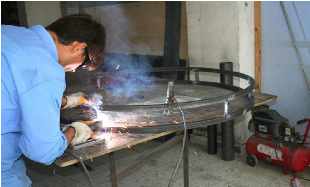
Şekil 3.13 İmalat Bölümü Dış Cephe Reklam Tasarımı Karkas Oluşturulması
