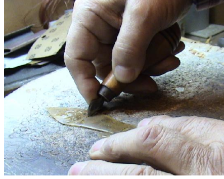
Resim – 52 Deriye Nevregan ile delik açılırken (istop)
