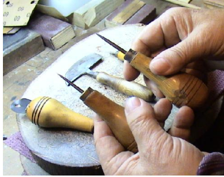
Resim – 47 Farklı boyutlarda delik açan Bizler
