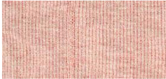
Şekil 2-82 Kanca eğilmesiyle kumaşta oluşmuş boyuna çizgi görünümü
