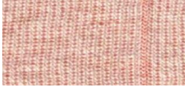
Şekil 2-88 Yeni takılmış iğnenin kumaş yüzeyindeki görünümü
