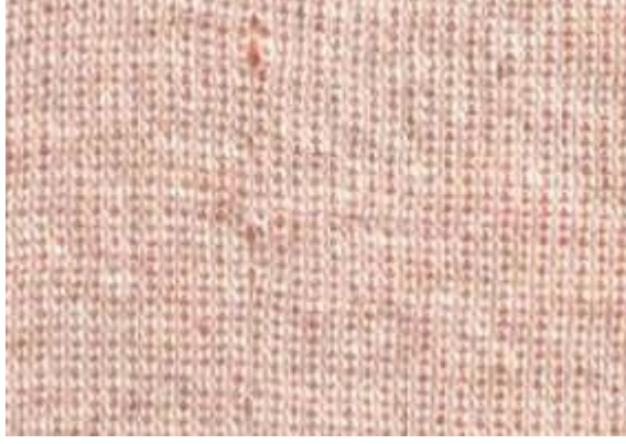
Şekil 2-94 İğne delikleri hatasının kumaş yüzeyindeki görünümü
