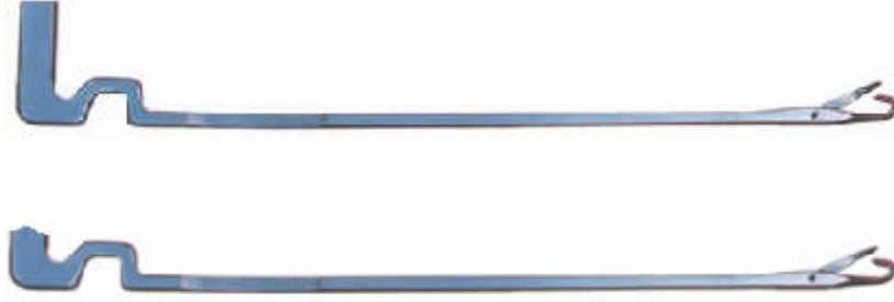
Şekil 2-85 Sağlam olan ve kırık olan iğne ayağı görünümü
