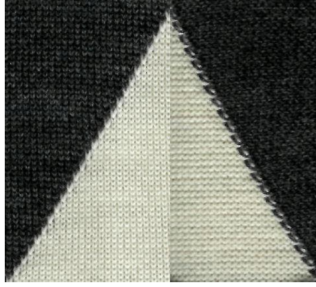
Şekil 2-105 Tek plaka intersia düz örme kumaş
