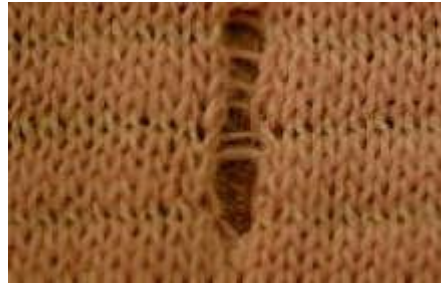
Şekil 2-86 Kırık iğne ayağı sonucu kumaş yüzeyindeki görünüm
