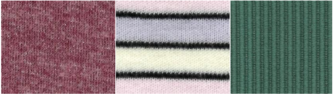
Şekil 2-117 Çift Plaka İnterlok Yuvarlak Örme Kumaşlar
