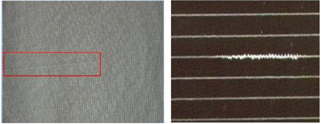
Şekil 2-67 Kalın ipliğin kumaştaki görünümü ve ipliğe sarılmış lif uçuntusu
