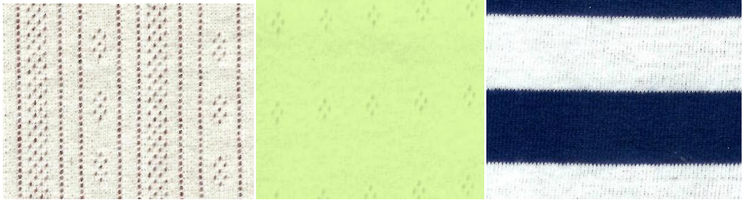
Şekil 2-116 Çift Plaka Ribana Yuvarlak Örme Kumaşlar / Transferli ve Çizgili Ribanalılar
