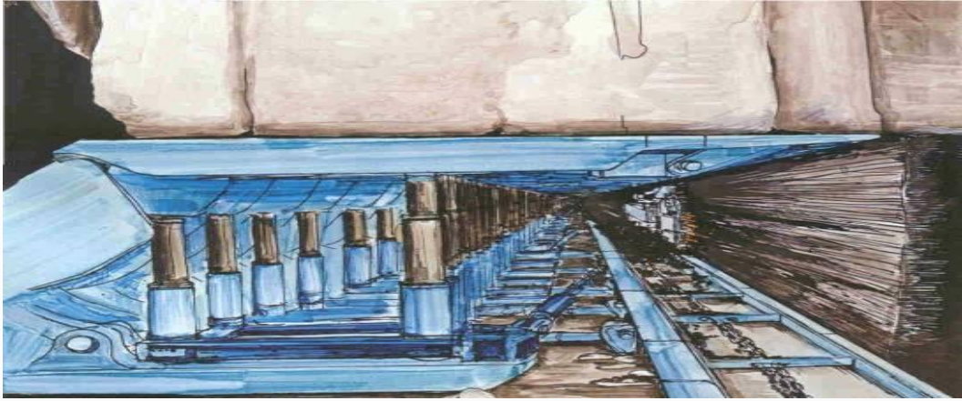
Şekil 14: Açılan galeride çökmeyi önlemek için yapılan destekler 47
