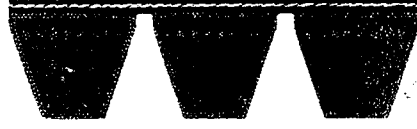
Şekil 1.7 Bantlı V Kayışın Yapısı [7]
